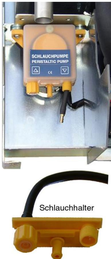
Bei dem Duftstoffpumpenschlauch handelt es sich um ein Verschleißteil. Es kann keine Garantie auf die Verträglichkeit der Schläuche mit allen auf dem Markt befindlichen Duftstoffen gegeben werden.
