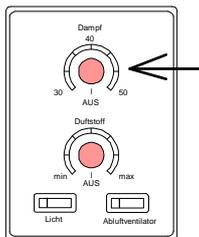
Durch Drehen des **oberen Drehknopfes** im Uhrzeigersinn wird der Dampfgenerator eingeschaltet und gleichzeitig die gewünschte Temperatur der Dampfbadkabine gewählt.
