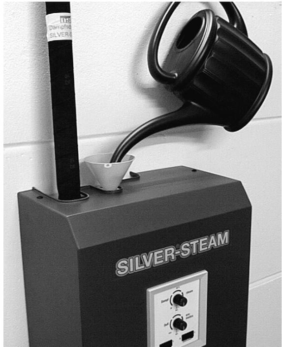
**Den Inhalt eines Beutels des **OSI** Entkalkungsmittels in 9 Liter warmem Wasser auflösen.**
