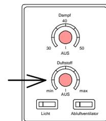
Durch Betätigung dieses Schalters kann der **Abluftventilator** außerhalb der Betriebszeit des Dampfgenerators ein- und ausgeschaltet werden.
