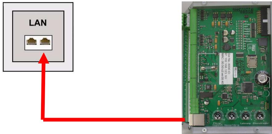
Nach dem der SILVER-STEAM mit einer aktiven Netzwerksteckdose verbunden wurde, kann die Spannungsversorgung eingeschaltet werden. Der osf-Webserver im SILVER-STEAM sucht nun eigenständig den osf-Kommunikationsserver und meldet sich in dessen Datenbank an.
