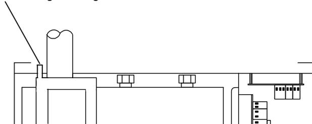
Im linken Edelstahlrohr (siehe Skizze) befindet sich eine Öffnung, die für die Belüftung des Systems unbedingt erforderlich ist. Diese Öffnung darf keinesfalls verschlossen werden. Ein Verschließen dieser Öffnung würde unweigerlich zu Funktionsstörungen der Anlage führen. Falls bei Betrieb der Anlage aus dieser Öffnung Wasser austritt, ist möglicherweise der Abfluss nicht ausreichend dimensioniert oder verstopft.
