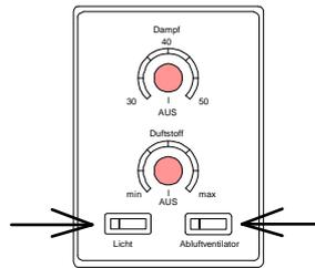
Durch Betätigung dieses Schalters kann die **Kabinenbeleuchtung** manuell ein- und ausgeschaltet werden.
