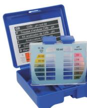
425353 **Astral Pool Testgerät**, mit Chlor und pH-Flaschen
