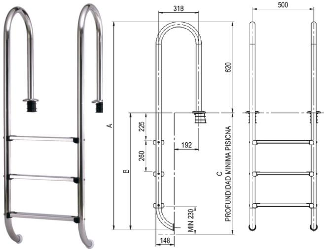
**Mit Ankersockel - enger Holm D 43 mit rutschsicheren Auftrittsstufen**
