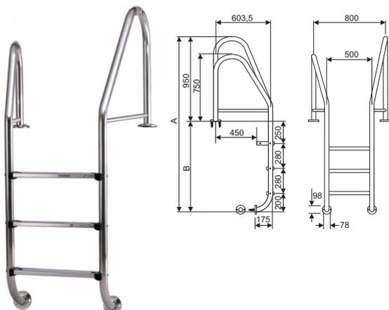
**mit Flanschmontage D 43, Holme verschieden hoch und ausgestellt, mit Sicherheitsstufe und Stufen De Luxe**
