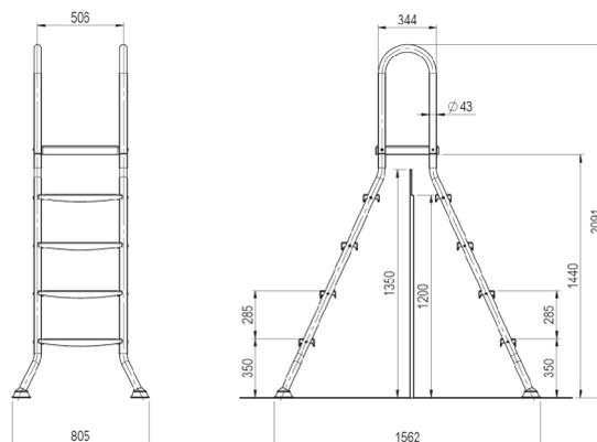
**SICHERHEITSLAITERN mit abnehmbarer Stufenseite in V2A**
