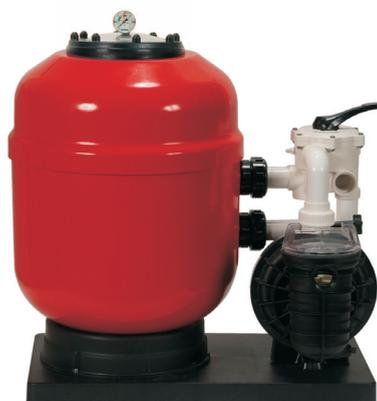
15872 **EUROPA-Kompaktfilter D 500 mm Farbe rot mit 6-Wege-Ventil verrohrt und Filterpumpe Duraglas I D1 salzwasserbeständig 0,4%, 0,56 KW, Wechselstrom 230 V (steckerfertig), montiert auf Bodenplatte (ohne Filtermaterial) Abmessungen: L x B x H; 80 x 82 x 92 cm**
