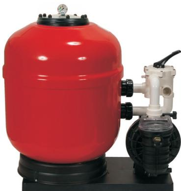
15890 **EUROPA-Kompaktfilter D 600 mm Farbe rot mit 6-Wege-Ventil verrohrt und Filterpumpe Duraglas I E1 salzwasserbeständig 0,4%, 0,75 KW, Wechselstrom 230 V (steckerfertig), montiert auf Bodenplatte (ohne Filtermaterial) Abmessungen: L x B x H; 100 x 75 x 98 cm**
