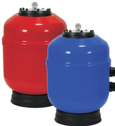
441613FL **Polyesterfilter Typ EUROPA D 500 mit Manometer, (ohne Ventil), Flansch Deckel transparent Farbe rot, Anschluss 1 1/2", H 810 mm, ohne Filtermaterial, Gewicht 22 kg**
