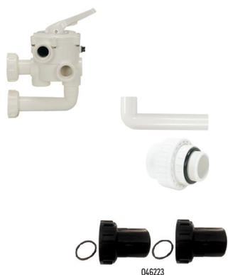
04443WK **6-Wege-Ventil 1 1/2" I.G. weiß, fertig verklebt zu Filter passend, inkl. O-Ringe zur Filterverschraubung Rohrabstand 125 mm**
