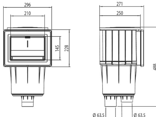
**i** **25 cm Tiefe speziell geeignet zum Einbau in Styroporbausteine**
