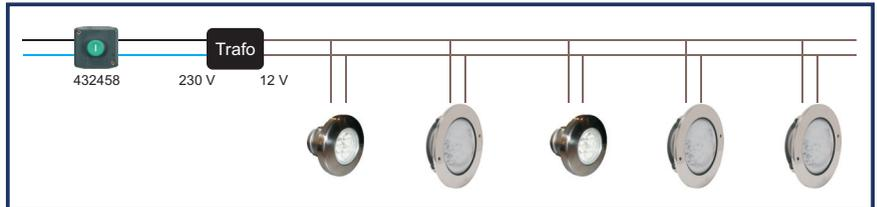
LumiPlus CONNECT Ansteuerung für Scheinwerfer mit Empfängermodul und optionaler Fernbedienung oder per WIFI-Adapter und App
